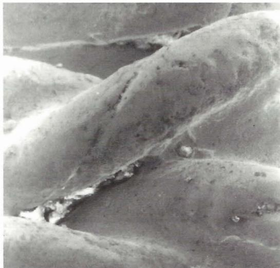
Lámina XI. Imagen tomada por MEB en la que se muestra con nitidez la naturaleza laminar de los hilos utilizados en la fabricación del pendiente fotografiado en la lámina anterior.
