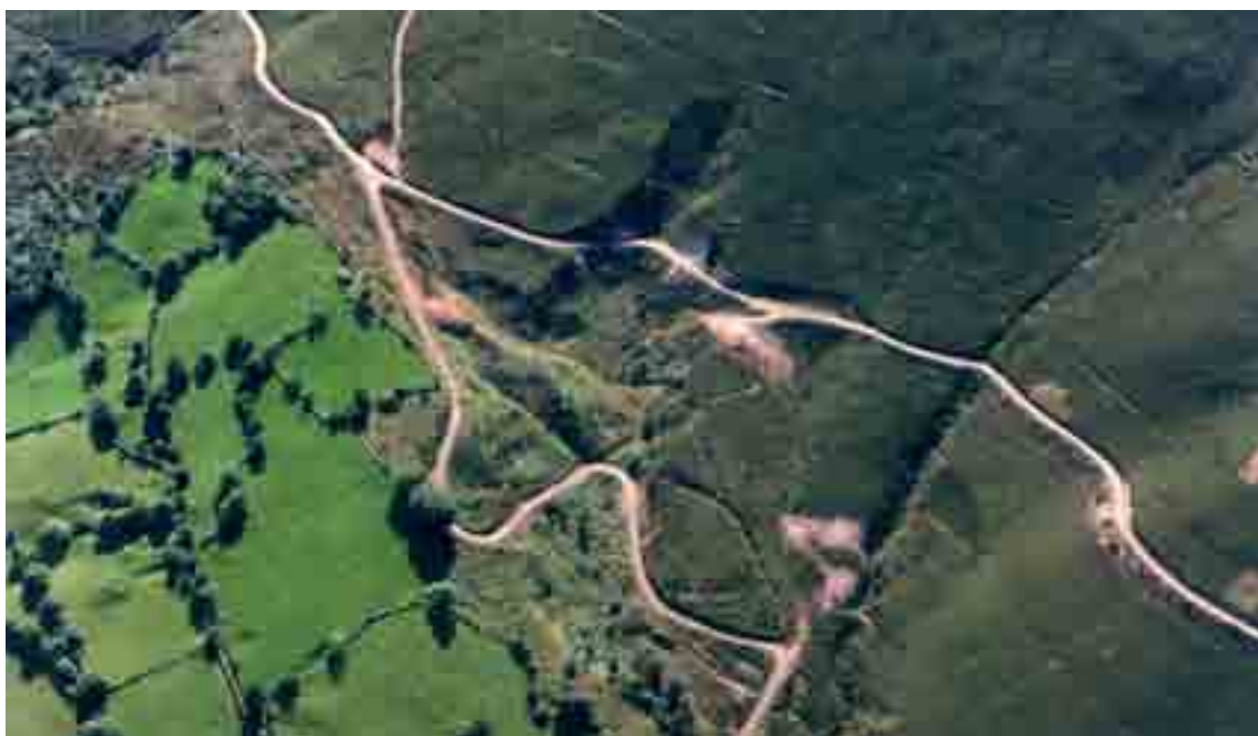
Fig 7. Explotación en Millara (Belmonte de Miranda). El avance paulatino de los frentes requería la actualización continua de la red de canales y depósitos pues una parte del sistema era inevitablemente destruido o inutilizado con el progreso de la mina, generándose de esta forma una tupida trama de infraestructuras a partir de la cual es posible recomponer las sucesivas fases del laboreo minero.
