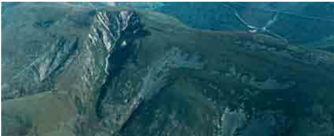
Fig 14. Ladera occidental de la Sierra del Palo (Allande). Sobre otras explotaciones menores destaca la corta de A Freita para cuyo beneficio fue necesario trazar una densa red de canales y depósitos que constituyen la muestra más expresiva y asequible de la pericia técnica alcanzada por los mineros del oro en época romana.
