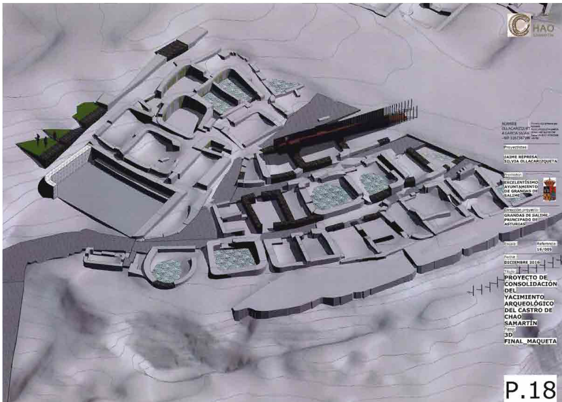
Ilustración 5. Plano 18. En él se observa la disposición de gaviones restituyendo estructuras "ausentes", así como la futura estructura denominada "mirador 3". Bermejo, J. y Ollacarizqueta Garda, S. (2016).
